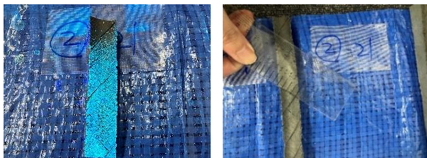
図2 クラック幅の計測
