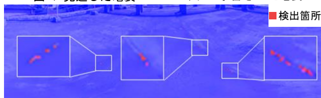
図 3 シート材はく離の画像解析結果
