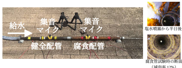
図-4 給水音実験の様子と腐食管の断面状態
