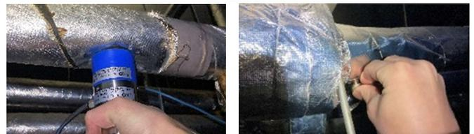
図5 検査の様子(左:超音波探傷、右:熱伝導率)
