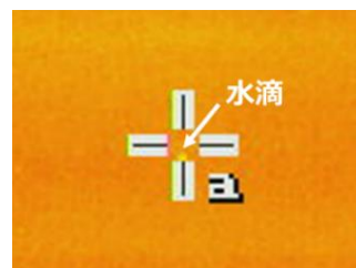
図4 検知可能な最小限の水量
