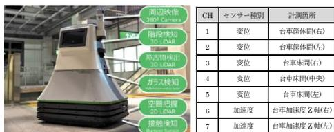
図1 自律移動型ロボット<sup>1</sup>と搭載センサの計測箇所
