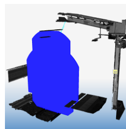
図2 モデル(1)による建築限界測定（K 駅）
